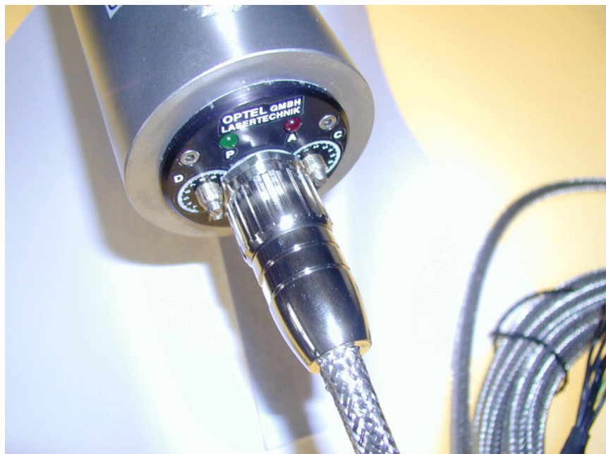
HLS-Empfänger mit trennbarem Anschlusskabel (optional)
