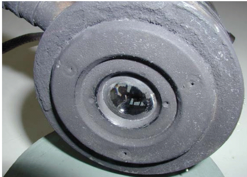
HLS-Sender im Kühlgehäuse mit "Gebrauchsspuren"
